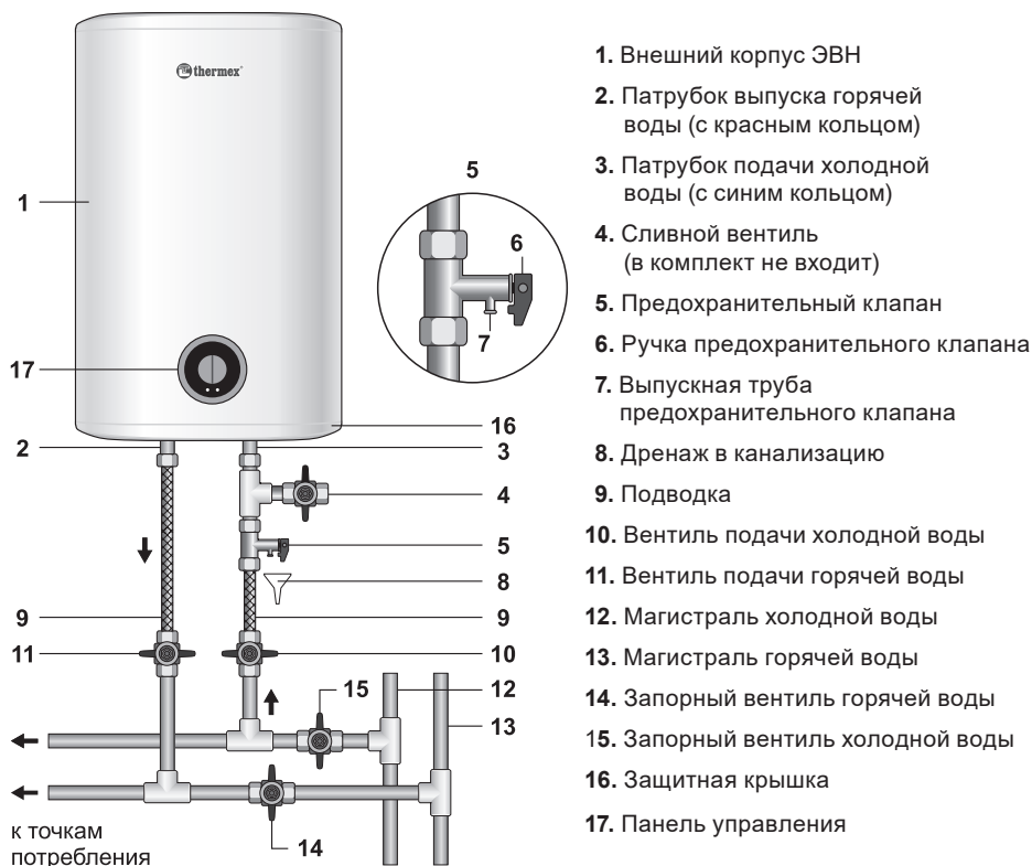
Рисунок 2. Схема подключения ЭВН к водопроводу.
